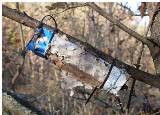
Obr. 4: Tubus zničený hlodavcami a vplyvom počasia Fig. 4. Tube destroyed by rodents and weather
