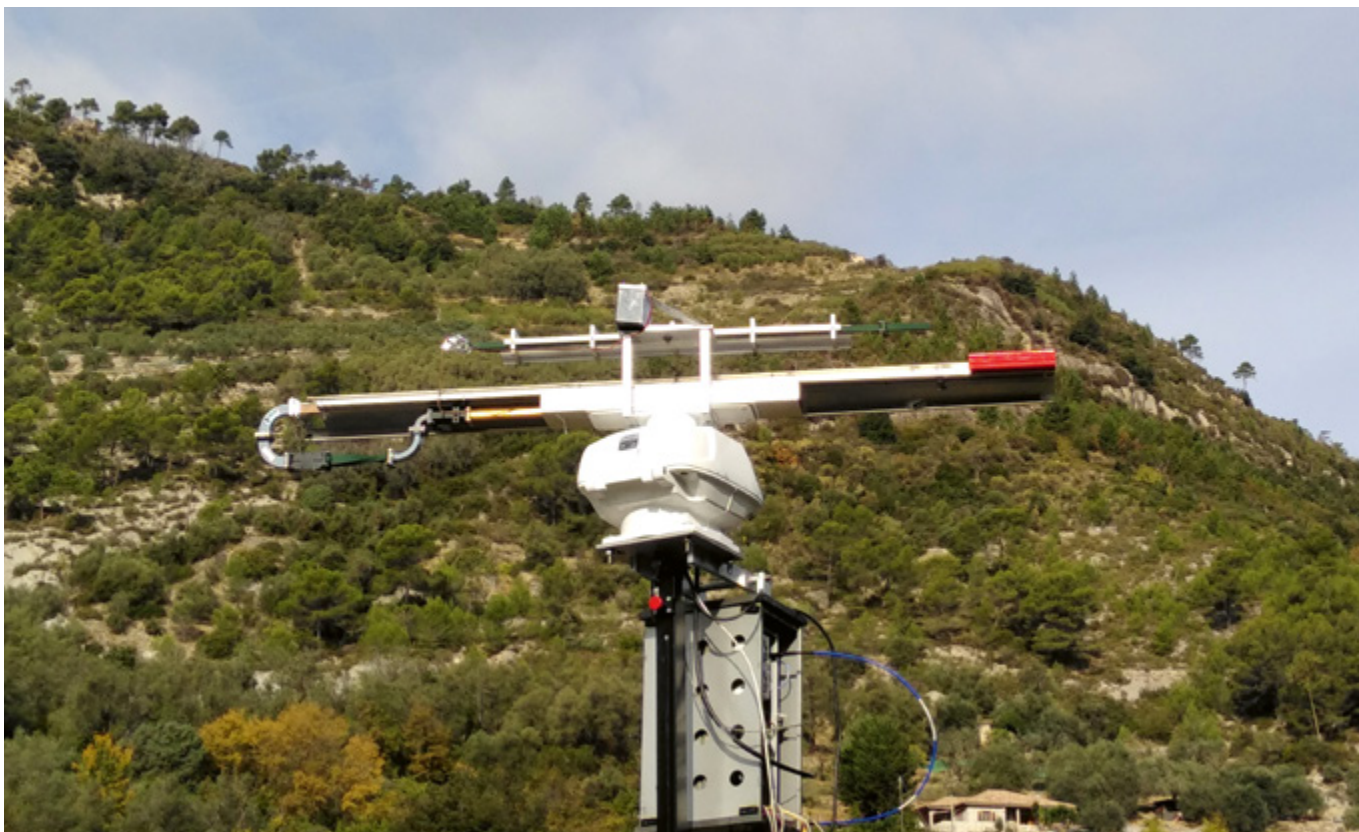
Obrázok 8: Harmonický radar vyvinutý v rámci projektu STOPVESPA [©LIFE STOPVESPA].
