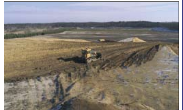
Záber z DP Šajdikove Humence – ukážka celoplošnej nivelácie terénu pri ťažbe piesku ťažkými mechanizmami
