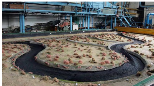
Obr. č. 2. Fyzikálny model úseku koryta Moravy v oblasti rkm 64,750 – rkm 66,250 na ktorom boli testované zmeny prúdenia a vyvolaných morfologických zmien koryta meandrov pri rôznych prietokových situáciách. Okrem morfodynamickej stability sa posudzovalo vytváranie nových biotopov koryta. 14
