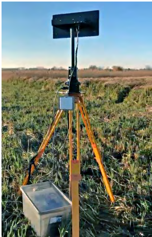
Obr. 3: Rádiotelemetrická veža s anténou rádiového prijímača, foto: J. Košša
