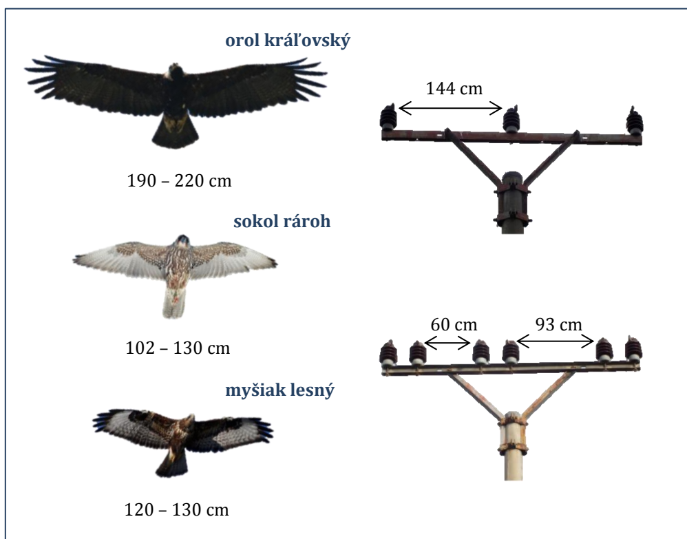
Obr. 9 Príklady potenciálnej hrozby zásahu prúdom vybraných druhov dravcov a porovnanie veľkosti rozpätia ich krídel voči najbežnejším typom stĺpov 22 kV v krajine
